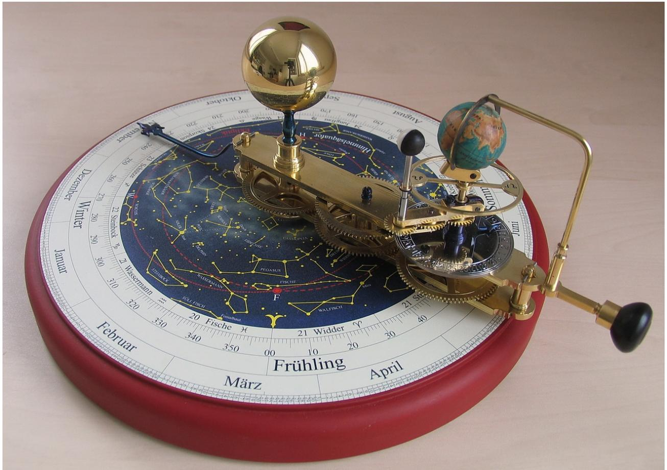
Dieses Tellurium ist einem Historischem Tellurium nachempfunden. Die Mechanik besteht aus Messing und Gebläutem Stahl. Die Metallteile wurden maschinell gefräst, oder gedreht und von Hand nachgearbeitet. Das Handgravierte Mondzifferplatt ist aus Messing und versilbert.
