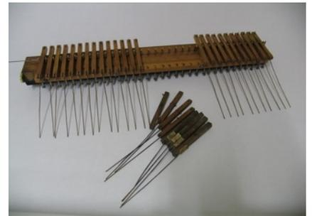
Klavierholz, Clavis und Stecher wurden zerlegt, gereinigt und nach dem Einbau in Höhe und Breite nach Schablone ausgerichtet.
