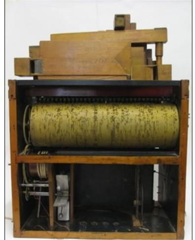
Antriebswerk: Bestehend aus Bodenrad mit Holztrommel,
