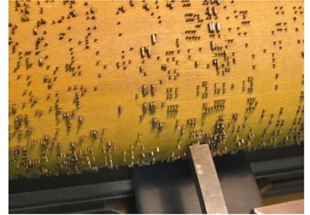
Die Stiftwalze wurde gereinigt und mit Hilfe einer Lehre auf dem Drehbank alle Stifte in Höhe und Spur gerichtet. Fehlende Stifte sind ergänzt worden.
