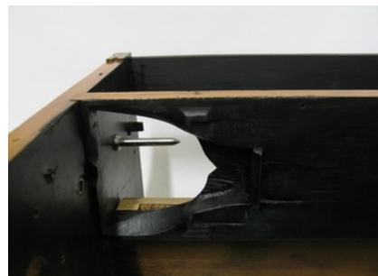
Die obere Gestellquerleiste ist nicht original und passt nicht in die Verzinkung. Sie wurde durch eine neue Leiste ersetzt.
