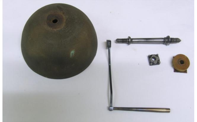
Zwei Messinghalter mit Stahlschrauben und eine Stahlfeder für die Hammerwelle.
