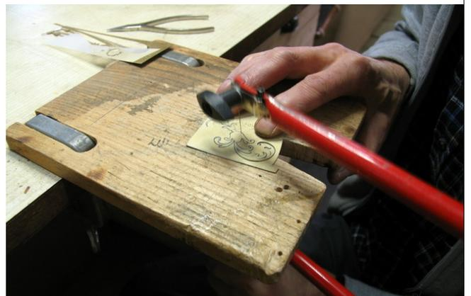
Ausgesägte Teile werden auf einer Gummiplatte mit Messingrolle Formgerecht gebogen.
