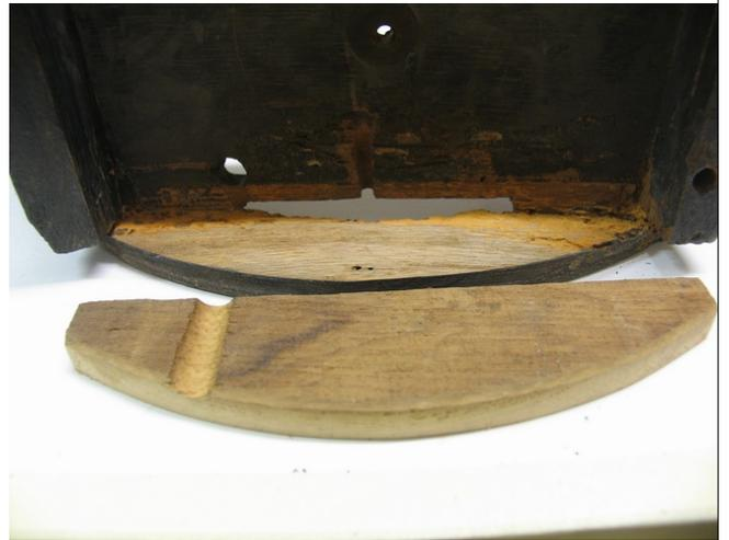
Die Konsole musste mit neuen Eckleisten verstärkt und neu verleimt werden, dazu wurde die Deckplatte entfernt. Risse wurden ausgespänt, Nagel und Wurmlöcher mit Leimgips gekittet.
